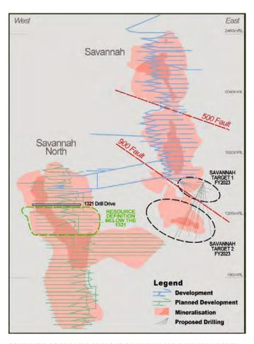
SCHEMATIC OF DRILLING AREAS AT SAVANNAH AND SAVANNAH NORTH IN THE FY22 AND FY23
